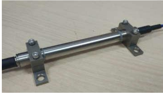
图 1 混凝土表面应变计实物图
